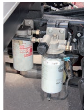
Топливный фильтр-сепаратор с подогревом и ручной подкачкой, налицо подготовка к российскому рынку
