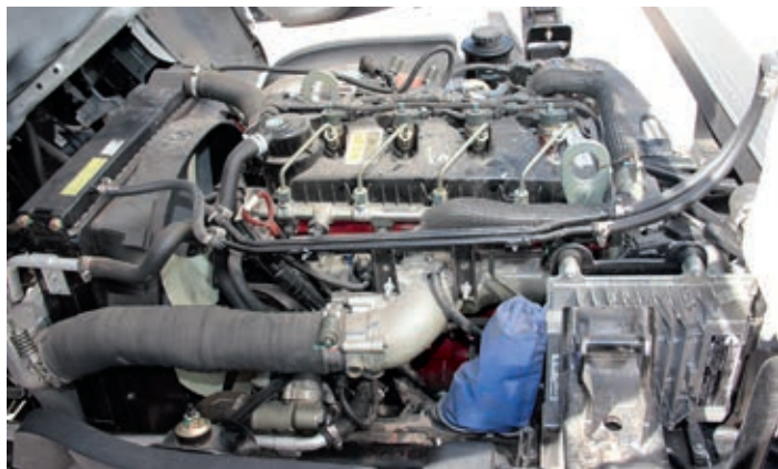
Лицензионный двигатель Cummins ISF2.8s4107 зарекомендовал себя неплохо, доступ для его обслуживания удобный благодаря тому, что кабина откидывается на большой угол
