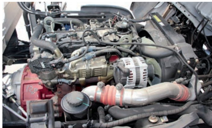
Лицензионный двигатель Cummins ISF2.8s4107 зарекомендовал себя неплохо, доступ для его обслуживания удобный благодаря тому, что кабина откидывается на большой угол
