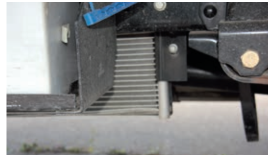
Конденсатор кондиционера с блоком вентиляторов расположен продольно и ниже всех, повредить его элементарно, будьте внимательны!
