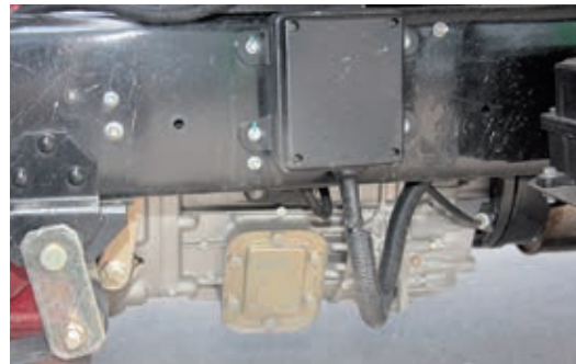
На КП предусмотрена возможность отбора мощности для привода оборудования надстроек
