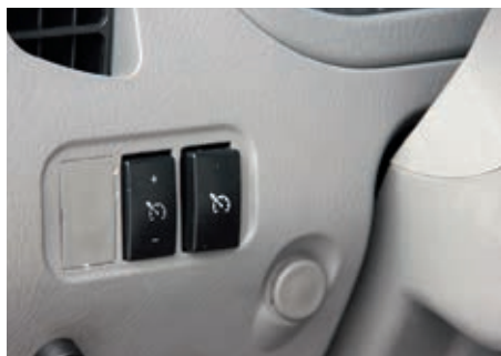
Необычно расположены и клавиши управления круиз-контролем – слева снизу, обычно их ищешь на рулевом колесе
